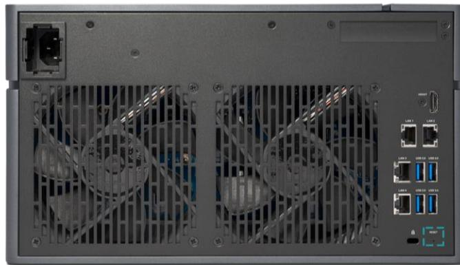
1. Réinitialiser les paramètres réseau : Appuyez et maintenez enfoncé le bouton de réinitialisation sur le panneau arrière pendant **3 secondes**, vous entendrez un bip court pendant 1 seconde. Le mot de passe administrateur et tous les paramètres réseau seront réinitialisés, la configuration du système sera la suivante :
