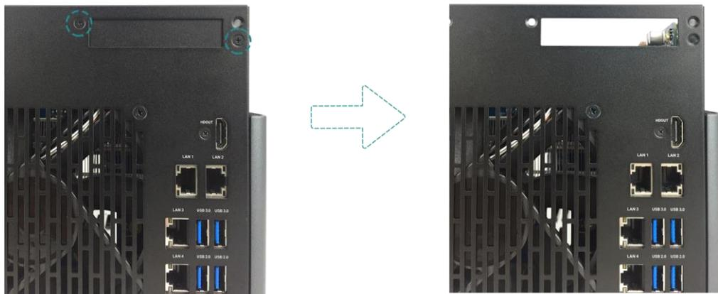
6. Alignez et insérez le connecteur de la carte dans le logement d'extension.
